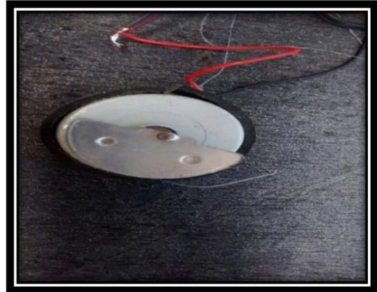
Figura 24: Conexión Motor Vibratorio
