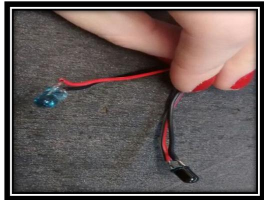
Figura 26: Sensores infrarrojos emisor y receptor
